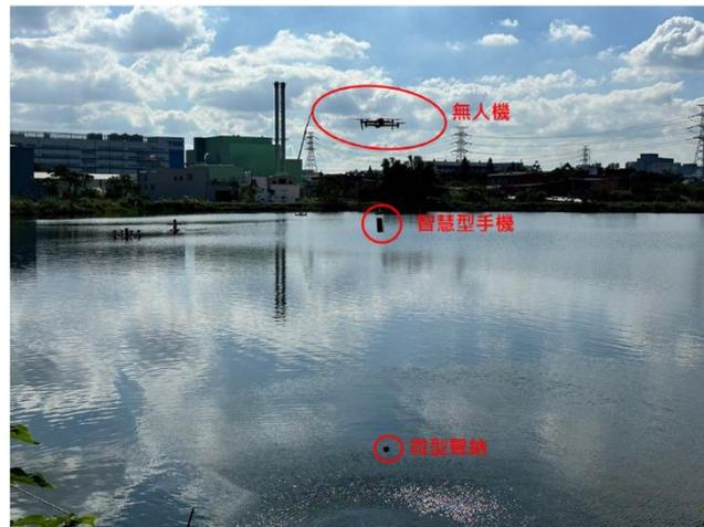
圖 2、無人機吊掛微型聲納施測作業圖
