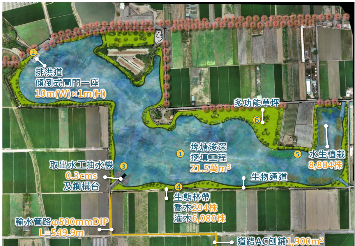
圖 4 林初埤活化調度設施強化工程
