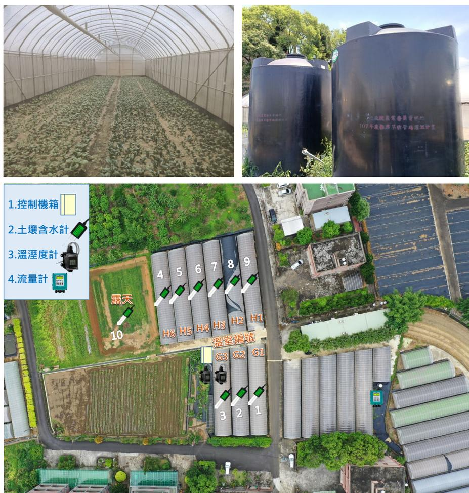
圖 4 田田圈有機農場設施現況與安裝元件配置情形
