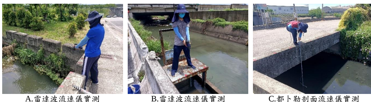
圖 2 渠道流量實測操作示意圖
