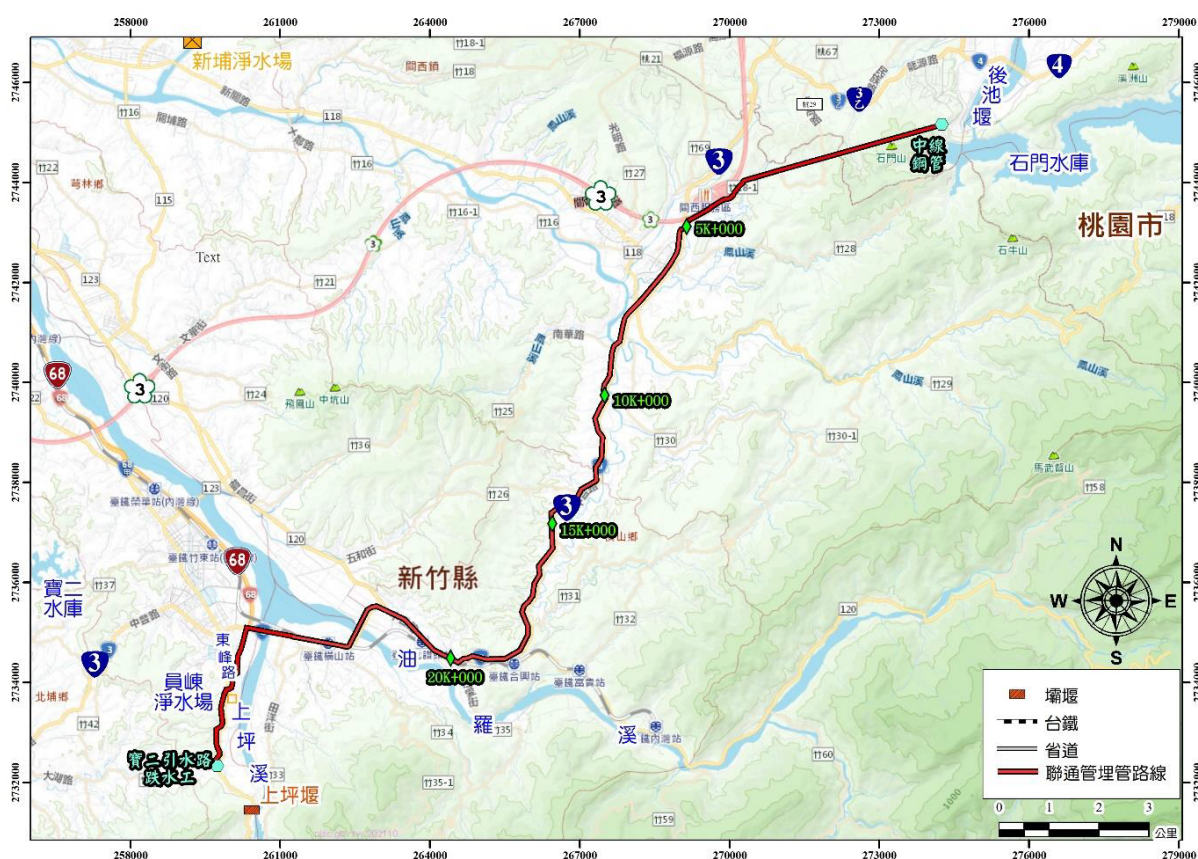
圖2 石門水庫至上坪堰原水聯通管布置圖
