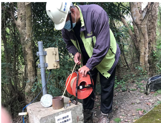
圖 3.1.15 人員現場量測地下水位
