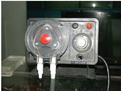
圖 9 蠕動式馬達灌溉示意圖
