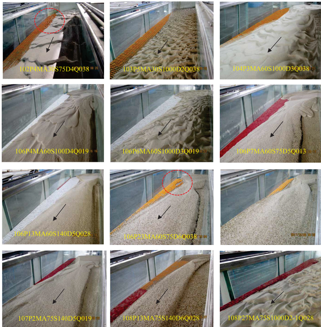
圖 6 保護試驗後塊體完整與傾倒案例
