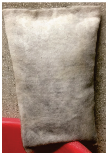
圖 6 分槽試驗之濾材包
