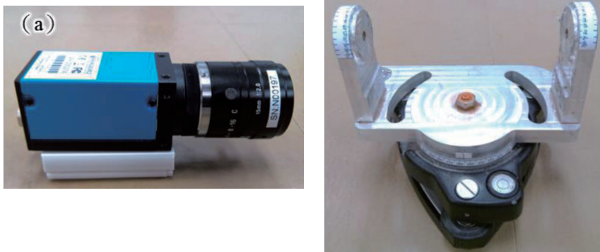
圖 10 (a)工業相機 ICDA-acA1600-20gc；(b) U 型架與水準氣泡。
