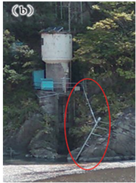
圖 3 玉峰水位站所設置之(a)雷達波水位計及(b)壓力式水位計。
