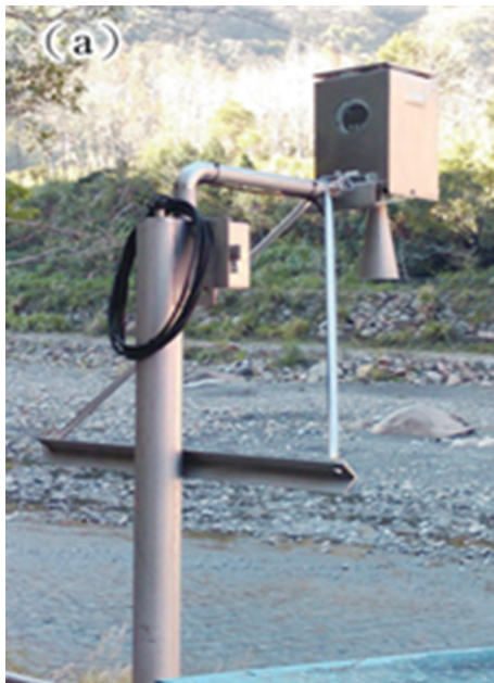
圖 3 玉峰水位站所設置之(a)雷達波水位計及(b)壓力式水位計。
