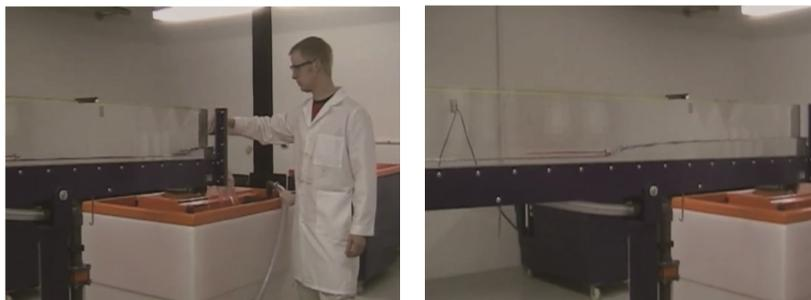
圖 7 下游擋板控制的水躍試驗
