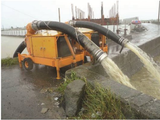
圖 17 水利署所配置之移動式抽水機(每一台最大抽水量為 0.35 \text{ m}^3/\text{s} )
