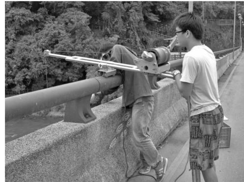
圖 6 以鉛錘測取河川斷面
