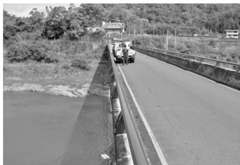
圖 4 透地雷達量測河川通水斷面
