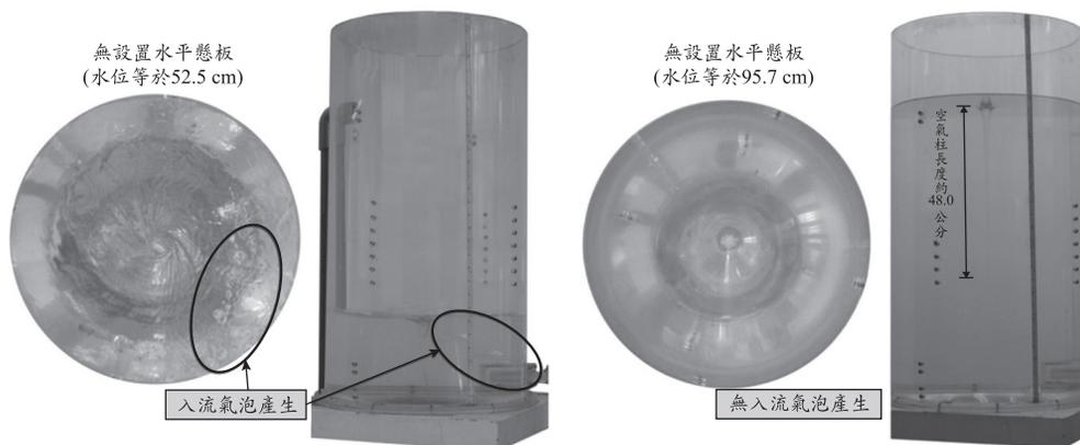
圖 5 無設置水平懸板時排砂器內清水渦流觀察
