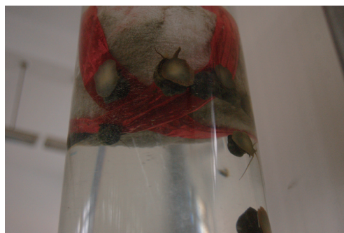
圖 4 福壽螺於圓形壓克力管柱實驗中停留於阻隔障礙物中情形
