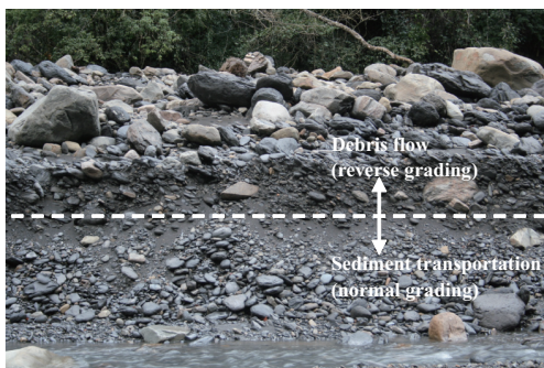
圖 1 野溪河床堆積之垂直粒徑分佈(野溪發生洪水事件後，再發生土石流事件。虛線以上為土石流發生後之粒徑分佈，大顆粒在上層；虛線以下則為河川輸砂之沈積，大顆粒在下層)
