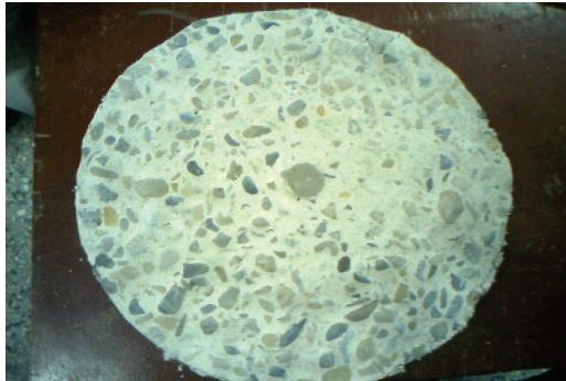
照片 1 0.5% 聚丙烯棄邊絲混擬土試體水中磨損之情形(水灰比 0.45)
