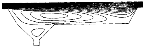
圖 11 重力沉降室之速度流線圖（集塵棚架於左側位置）
