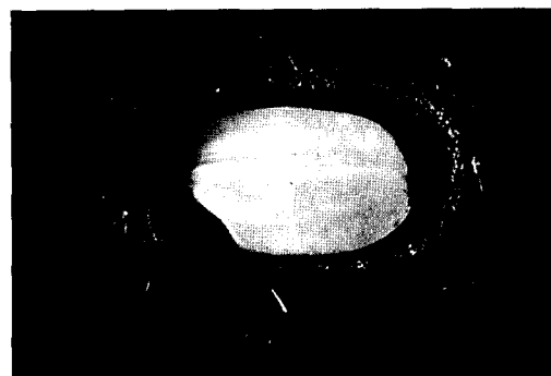
圖 6 胴裂粒於承載皮帶上方打光
