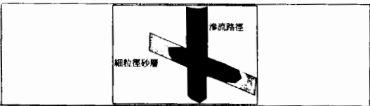
圖 4-3. 穿過細粒徑砂層時的路徑
