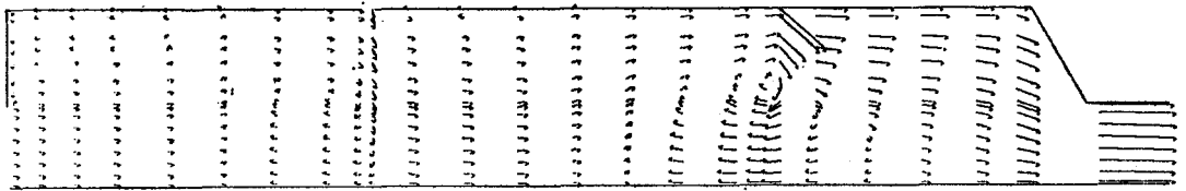
圖二十五 三次通風口噴射角 \beta 對速度場之影響 ( \alpha=45^\circ, \beta=45^\circ )
