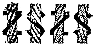
圖 2 鋼索繞股法之種類
