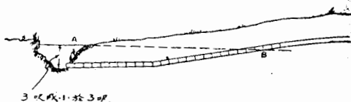
第7圖 暗管排水不良之出口
