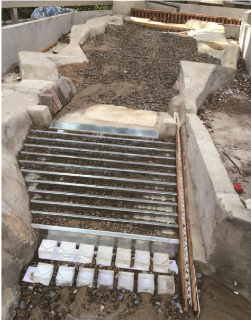
圖 6 十文溪一號壩改善規劃魚道水工模型。
