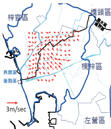
圖 27 重現期 50 年最大流速分布(合併模擬)
